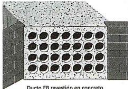
Ducto EB revestido en concreto
